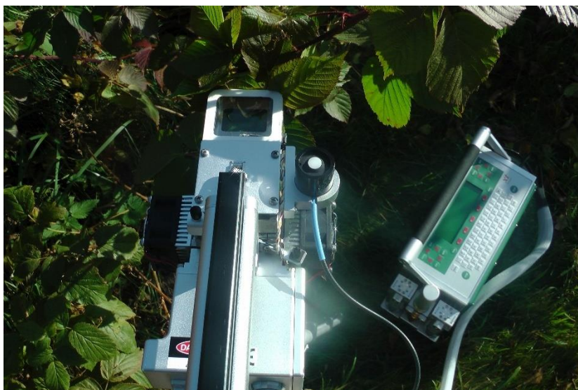
Obr.7.1 Přístroj pro gazometrické měření fotosyntézy a transpirace LI 6400 XT
