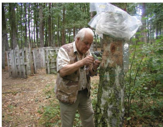
Obr. 7.9 a, b Soběšice, Výzkumný pozemek Mendelovy univerzity, kde probíhala měření transpiračního toku. Instalace sond na měření transpiračního toku v bříze bělokoré (na snímku prof. Jan Čermák).
