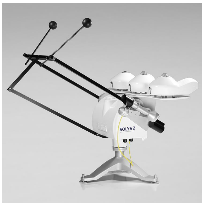
Obr.13. 4 Radiometry a pyrheliometr na naváděné montáži se stínícími terčíky na měření difuzního záření
