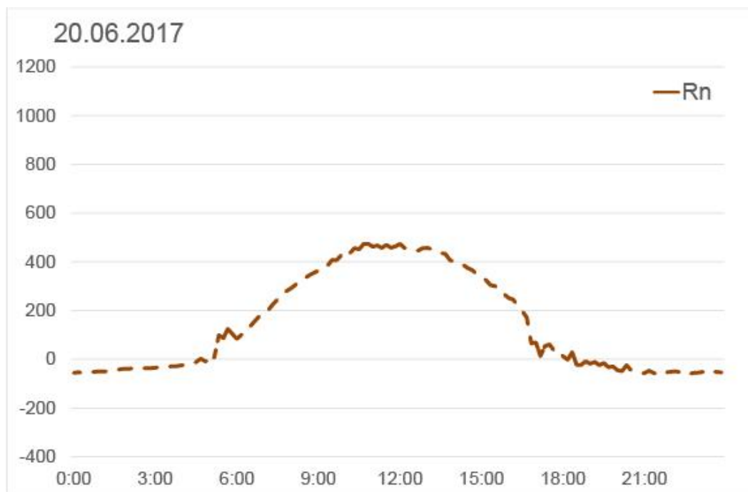
Obr. 5.6 b Čisté krátkovlnné RnS (sluneční energie po odečtení sluneční energie odražené) a čisté dlouhovlnné záření RnL (dlouhovlnná radiace/tok tepla mezi povrchem země a oblohou).
