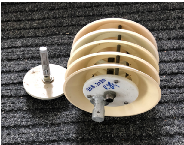
Obr. 17: Čidlo pro měření teploty a relativní vlhkosti vzduchu s radiačním krytem (vlevo) a USB čidlo pro měření teploty a relativní vlhkosti vzduchu umístěné u dubu
