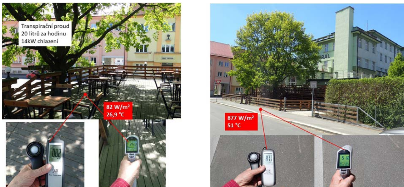
Obr. 15: Měření ozáření a povrchové teploty. Na volném prostranství je za jasného letního dne intenzita slunečního záření i teplota velmi vysoká. Ve stínu stromu je naměřená povrchová teplota i intenzita slunečního záření mnohem nižší. Obdobné hodnoty lze naměřit v těsném okolí jakékoli školy. Žáci se tak přesvědčí o chladící schopnosti stromu a se znalostí tohoto principu zvažují roli vegetace v krajině.
