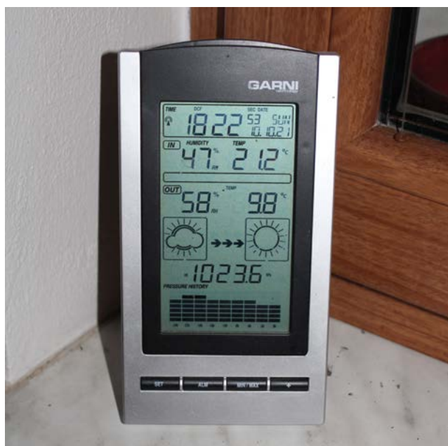
Obr. 17: Příklad malé automatické „meteostanice“ ověřené ve výuce
