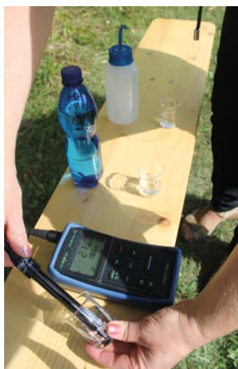
Obr. 28: Terénní měření vodivosti kapesním konduktometrem
