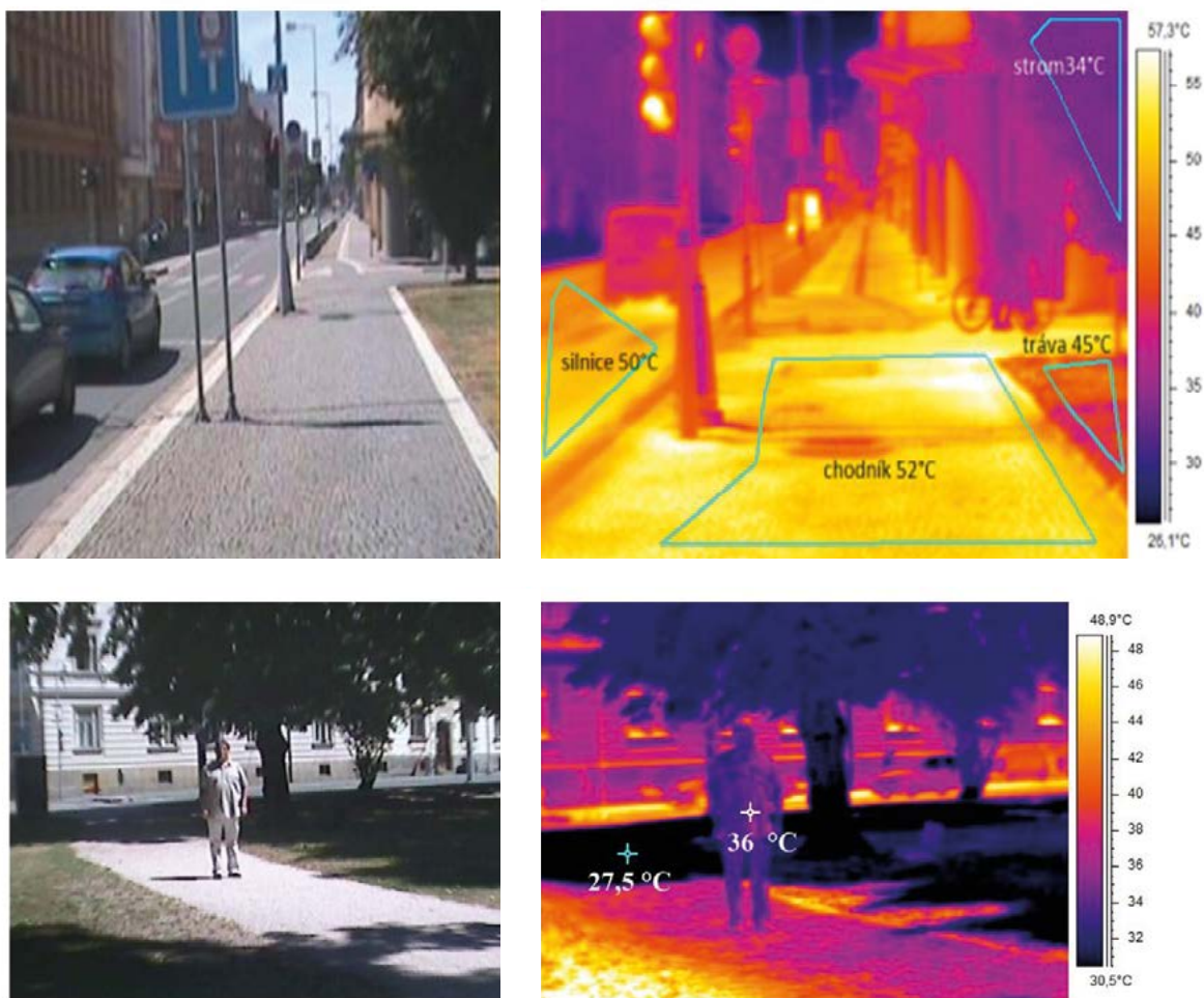
Obr. 18: Na ulici bez stromů má za slunného letního dne povrch chodníku teplotu přes 50 °C, sluneční energie se přeměňuje převážně na zjevné teplo (Gočárova třída v Hradci Králové). V parku pod stromem je povrchová teplota nižší než teplota lidského těla. Člověk se tedy ve stínu stromu ochlazuje.
