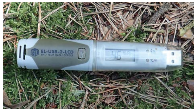
Obr.14: Čidlo pro měření relativní vzdušné vlhkosti a teploty vzduchu s USB konektorem
