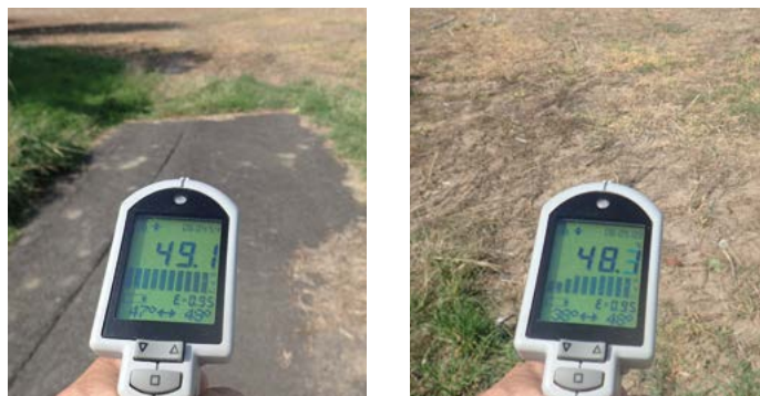
Obř. 15: Povrchová teplota asfaltu (49,1 °C) a podobná hodnota teploty sklizeného pole (48,1 °C), intenzita slunečního záření 650 W.m -2
