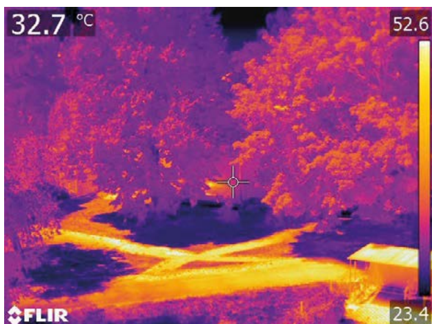
Obr. 20: Termovizní snímek dokumentuje chladící efekt stromů v parku. Nejnižší povrchová teplota je na travnaté ploše ve stínu stromu (23,4 °C), nejvyšší na povrchu plechové střechy (52,6 °C)
